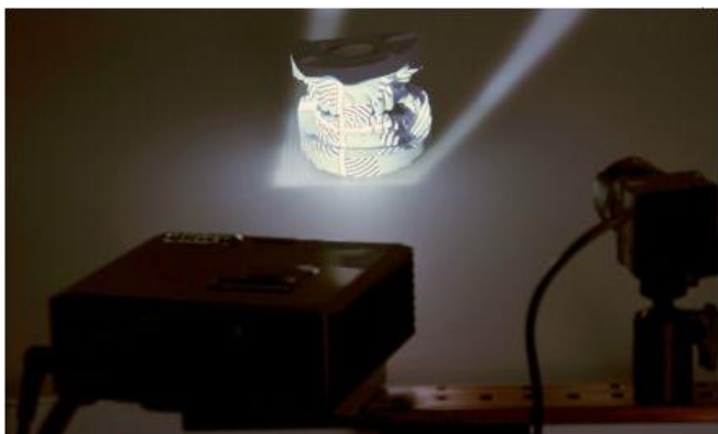
2pav. Gipsinių modelių skanavimas struktūrine šviesa[34]
